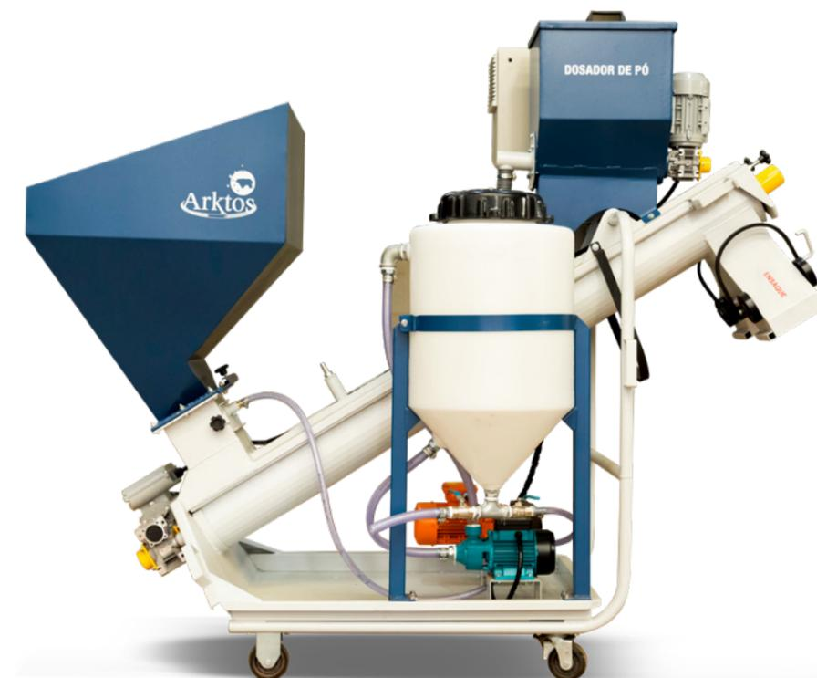
A ARKTOS 2020 DP é uma máquina de tratamento contínuo robusta, com grande durabilidade e baixa manutenção. Seu sistema de dosagem, com um tanque dosador, permite um tratamento preciso através de bomba dosadora de alta precisão, adequada para diversos tipos de semente.
