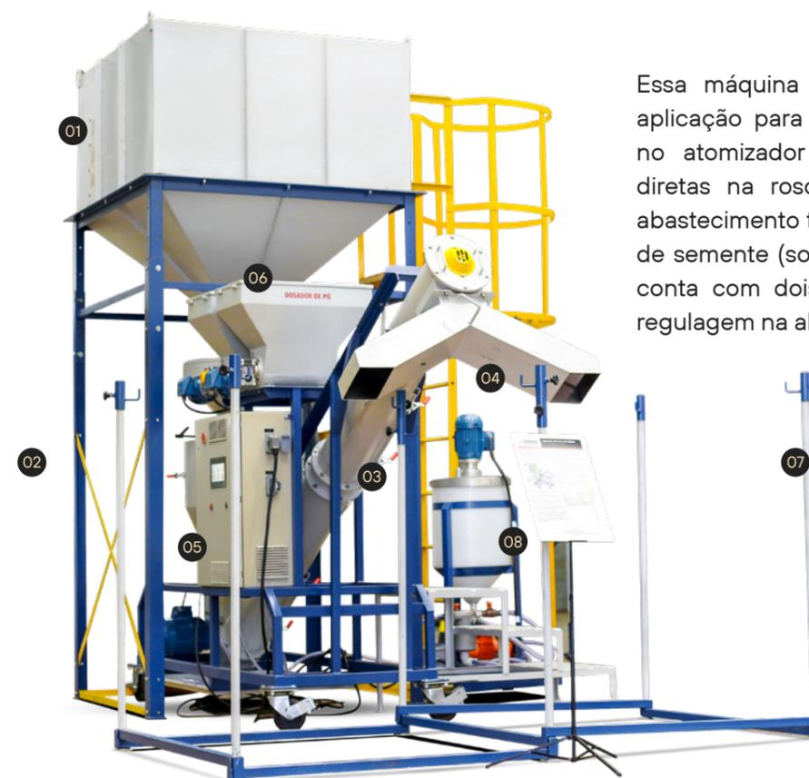
Essa máquina possui disponibilidade de aplicação para quatro tanques dosadores no atomizador e mais duas aplicações diretas na rosca sem fim. A moega de abastecimento tem capacidade de 1200 kg de semente (soja) e o sistema de ensaque conta com dois apoios de Big Bag com regulagem na altura para as alças.
